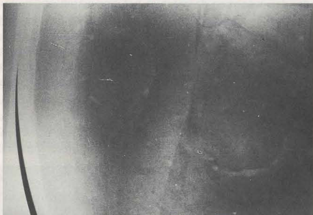
9. Niet alles wat bij het röntgenonderzoek zichtbaar werd kon duidelijk geïdentificeerd worden. Te zien is een aansluiting van twee houten segmenten van de binnenste bol. Kleine rondjes langs de naad geven bevestigingspunten aan. De twee cirkelvormige vlekken zijn mogelijkerwijs ingezette stukken in de houten spanen.
