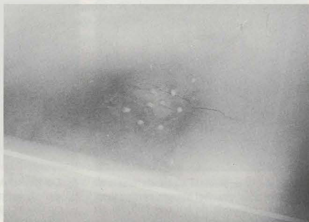
11. Op de plaats van een breuk bij Sagittarius op de hemelglobe kon op de röntgenfoto de breuklijn waargenomen worden. Het lijkt erop alsof spijkertjes door de bolwand heen naar binnen steken. Het feit dat de breuk door alle lagen van de globe heen loopt, heeft geleid tot een intensieve ingreep op deze plaats, waarbij het gips is verstevigd.
