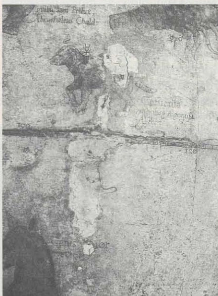
4. Bij het sterrenbeeld Canicula was een groot stuk van het papier verdwenen. Hier vertoonde de bol een bult die op de stoel aanliep. Door het schuren was het gat ontstaan. Door de druk die deze wrijving had veroorzaakt, waren de twee helften van de binnenste bol (die op de evenaar aan elkaar gepast zijn) een beetje gaan wijken. De hierdoor veroorzaakte breuk was circa tien centimeter lang.
